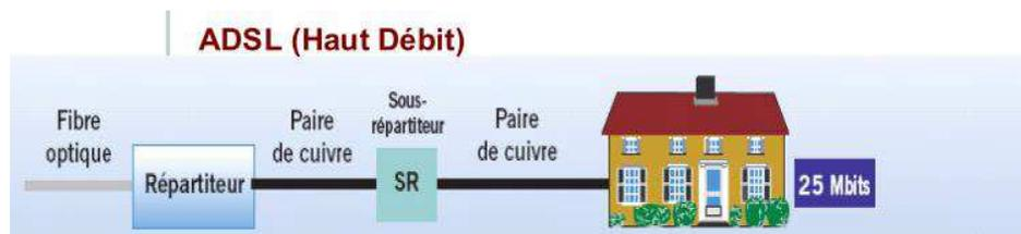
Le signal se propage dans les larges bandes de fréquences hautes, inutilisées par le transport de la voix en téléphonie traditionnelle.
